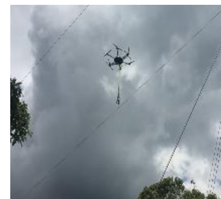
Fig.10. Toma de Corrientes con equipo Sensor Link
