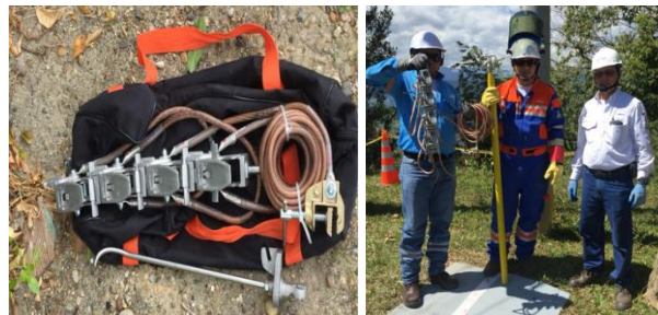
Fig. 7. Equipo puesta a Tierra B.T.
