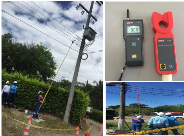
Fig. 2. Toma de Corriente con Pinza sensor Link
